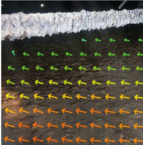
Abb. 2: Optische Bestimmung der Oberflächengeschwindigkeit in einer realen Anlage
