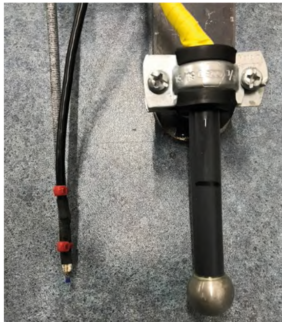
Abb. 1: Aluminiumkugel zur Bestimmung lokaler Strömungsgeschwindigkeiten – Wärmeübergangssonde (WÜS)
