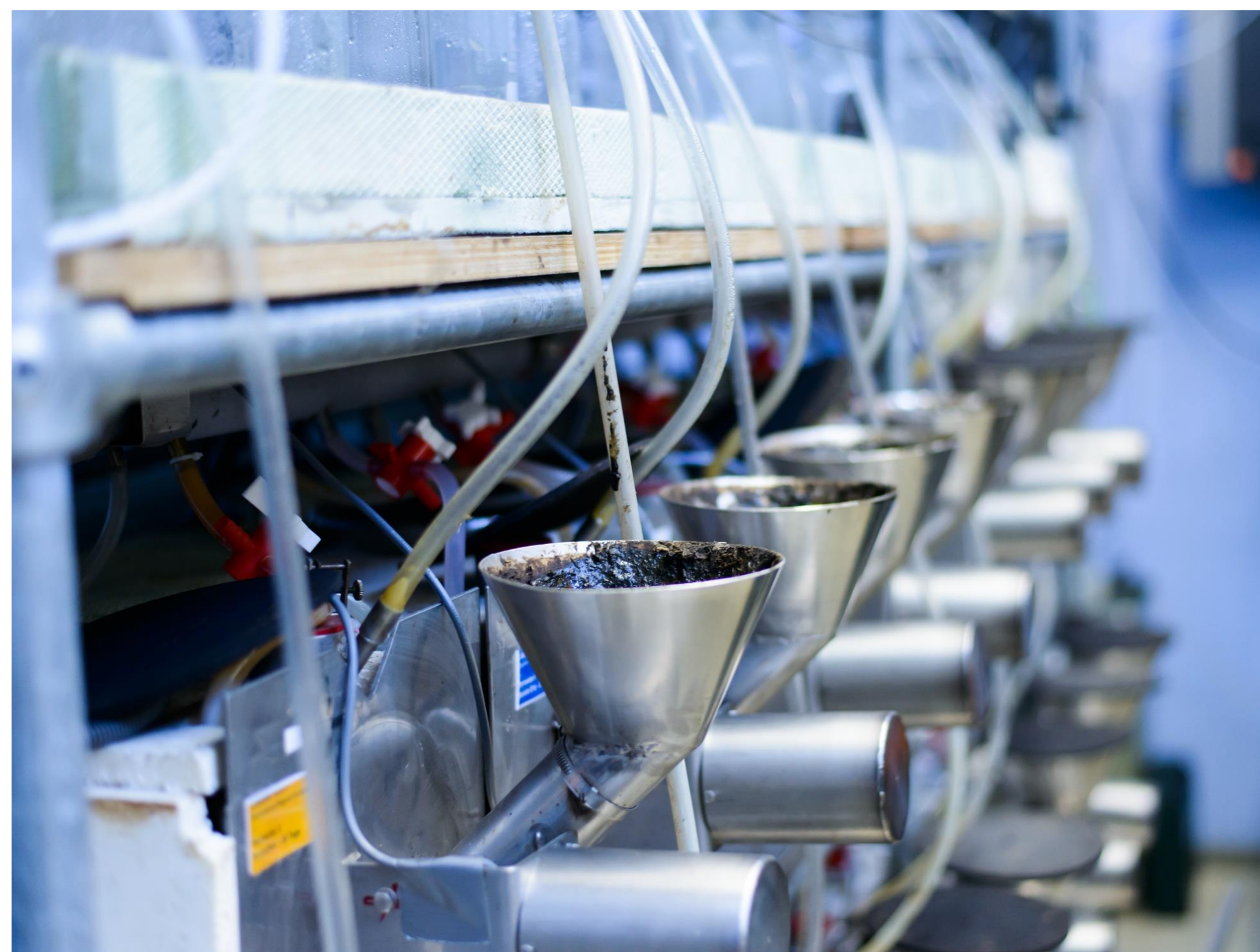
Abbildung 2 – Kontinuierlich betriebene Durchflussfermenter im Labormaßstab mit 17 l Faulraumvolumen
