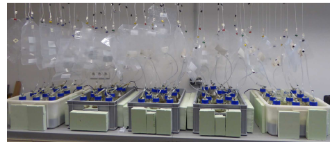
Laborbiogasanlage zur Durchführung der mesophilen Batch-Versuche
