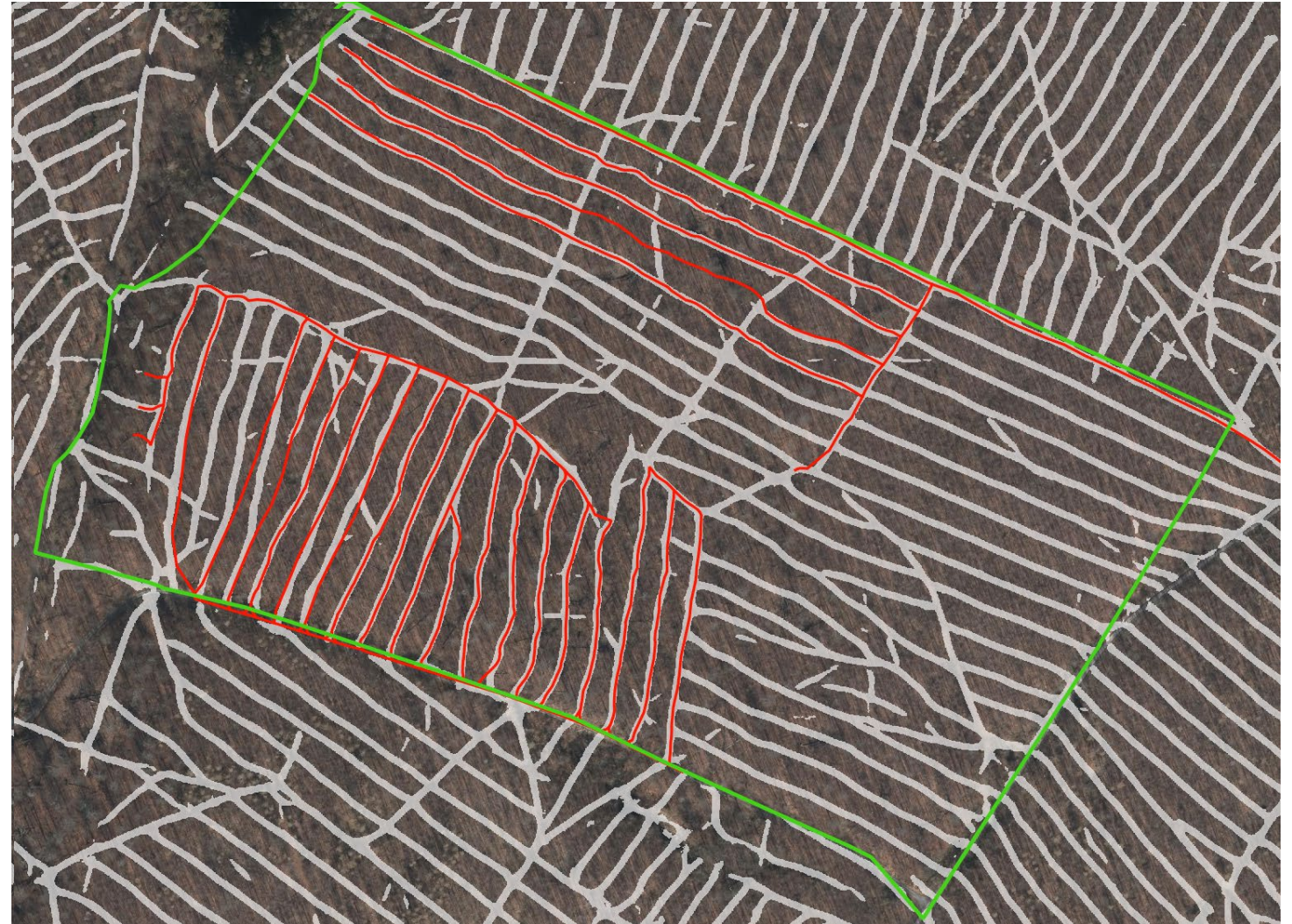
U-Net basierte Rückegassen (grau) überlagert mit RTK-GNSS Aufzeichnung eines Forwarders (rot)
