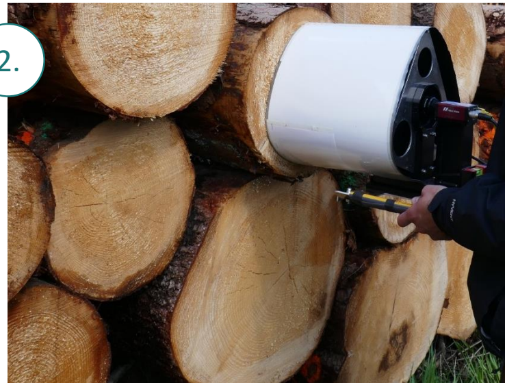
Bei Zwischenlagerung auf Polter mit handgehaltenem Lesesystem
