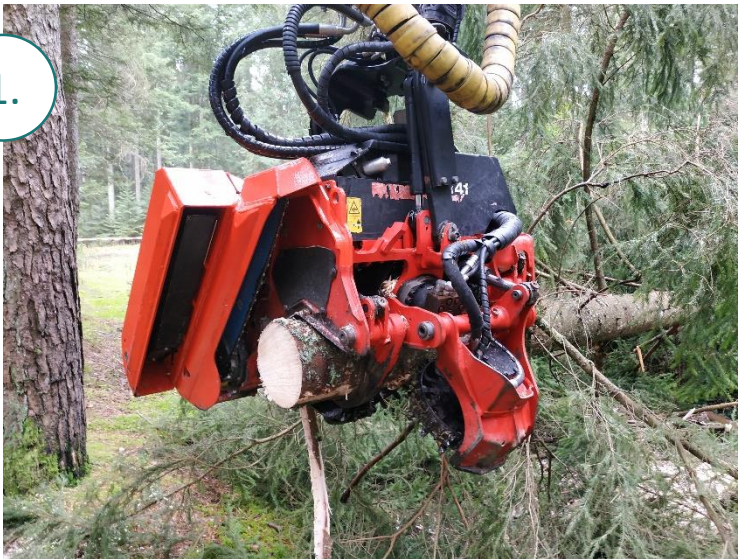
Bei Fällung und Aufbereitung mit Lesesystem im Vollernter-Aggregat
