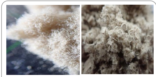
Zerfaserte Wellpappe, Zellulosefasern • Schüttdichte: 45 – 50 g/Liter • ph-Wert: 7,8
