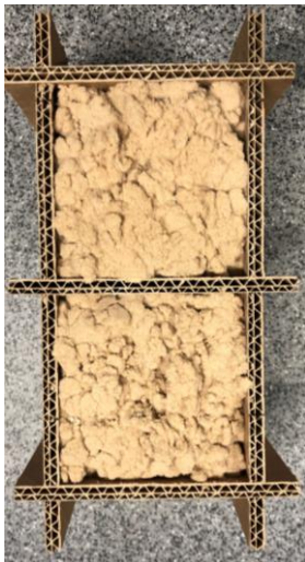
Probe mit Zellulosefaserdämmung
