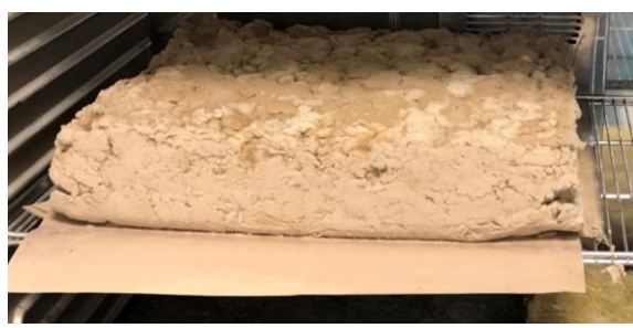
Zellulosefaserdämmung • Herstellung von Platten mittels Pressverfahren • z. T. Bindemittel
