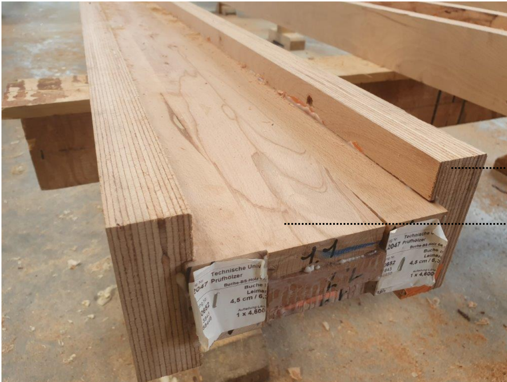
Standardisierte Buchenholz-Hybridträger großer Spannweite (STABU)
