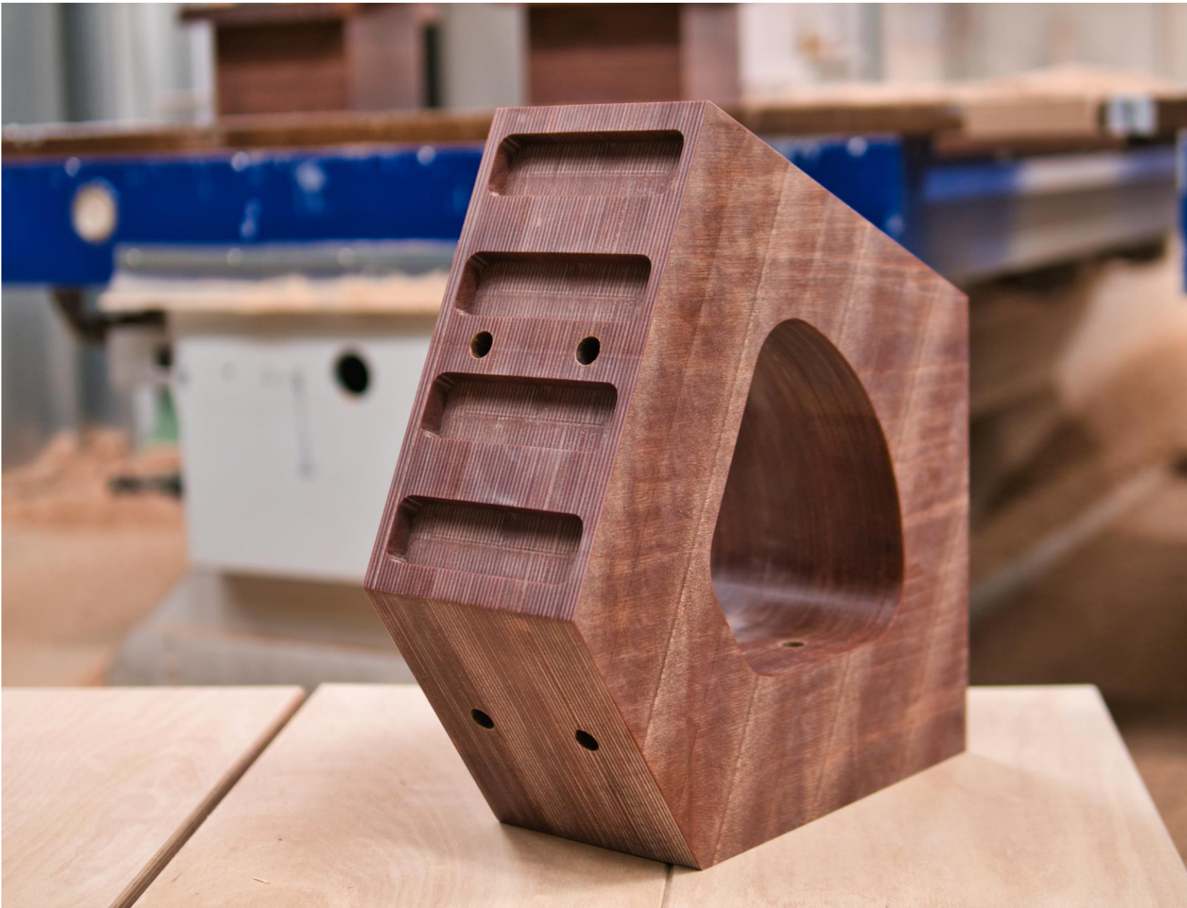
Traufknoten aus Kunstharzpressholz (KP); Querkraftanschluss über Schubnocken
