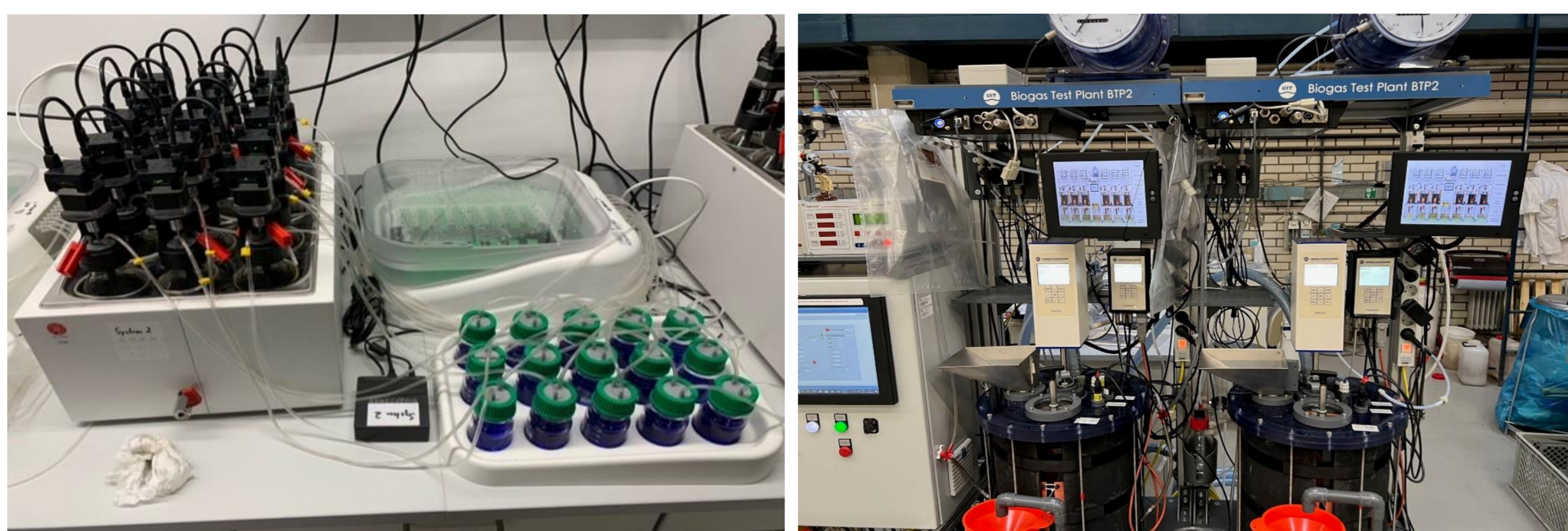
Abb. 2: Batchtest (links) und die Reaktoren für die kontinuierlichen Versuche (rechts)
