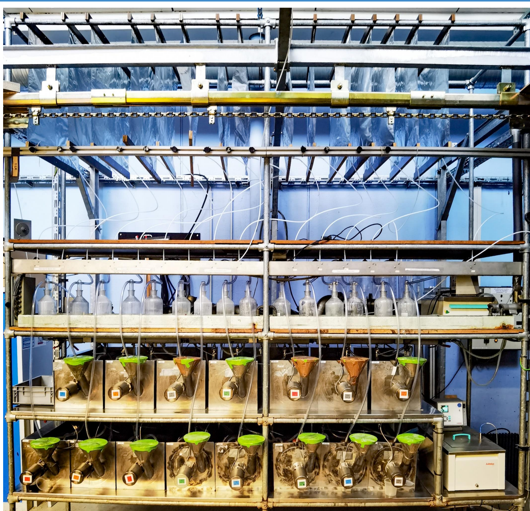
Abbildung 2 – Batchfermenter im Labormaßstab mit 17 Liter Faulraumvolumen
