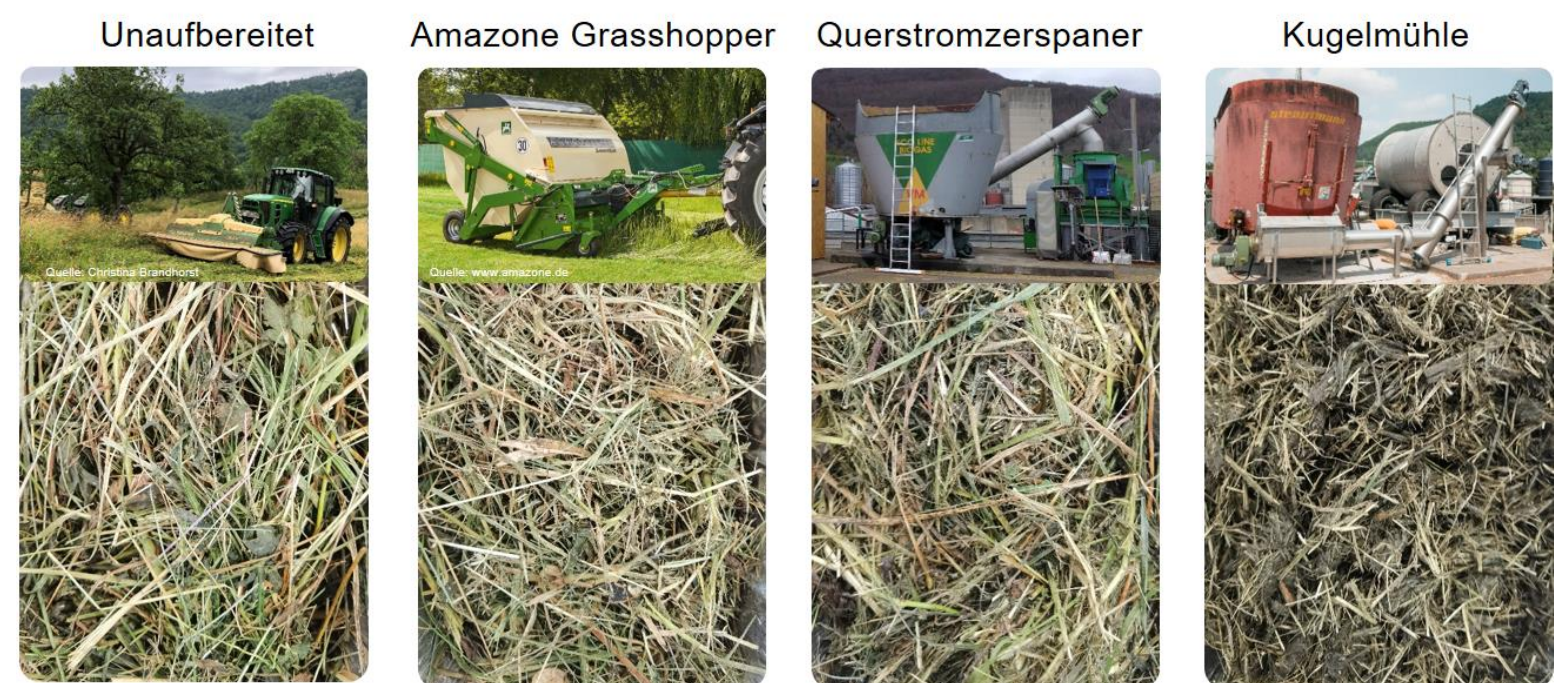
Abbildung 1 – Unaufbereitetes Landschaftspflegematerial und unterschiedliche mechanische Aufbereitungsverfahren
