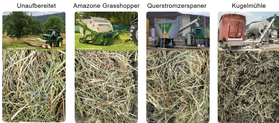
Abb. 1: Unaufbereitetes Landschaftspflegematerial (Bild 1) und unterschiedliche mechanische Aufbereitungsvarianten (Bild 2–4) (© Heller)
