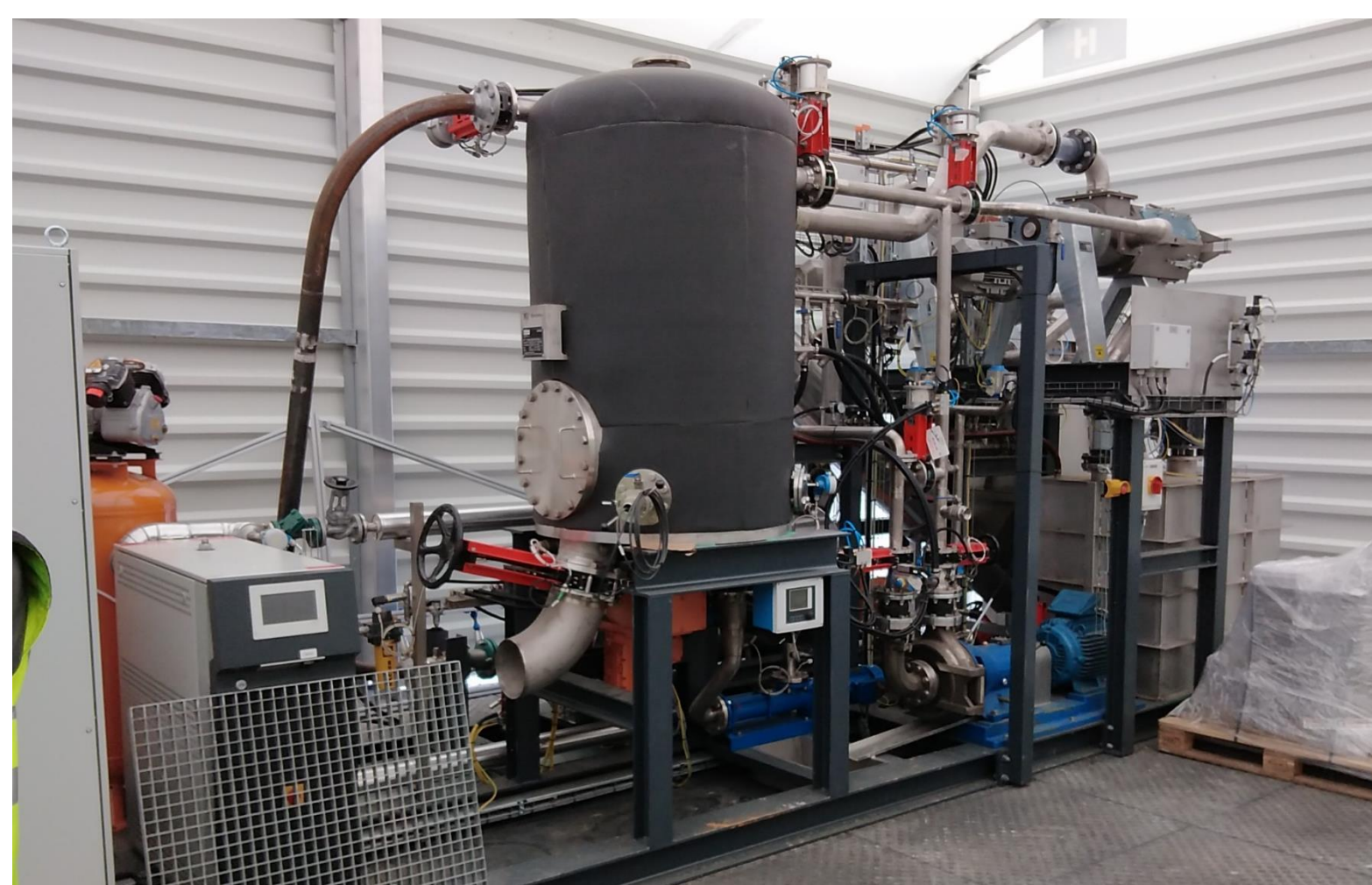
Aufbau der BW2Pro Bioraffinerie: Steam Explosion (links), Hochlastfermentation (rechts)
