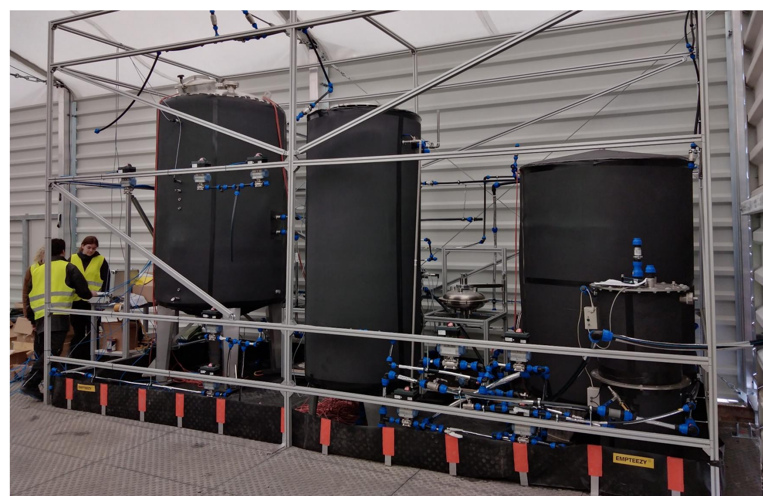
Aufbau der BW2Pro Bioraffinerie: Steam Explosion (links), Hochlastfermentation (rechts)
