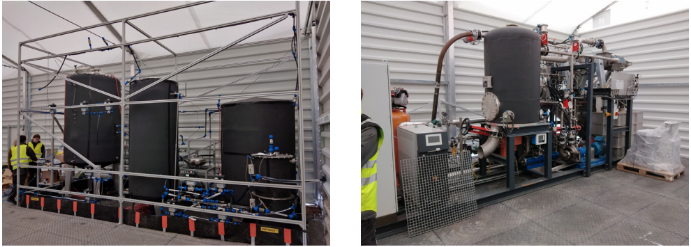
Abb. 1: Aufbau der Pilotanlage, links: 2-stufige Biogasanlage, rechts: Thermodruckhydrolyse (© Hülsemann)
