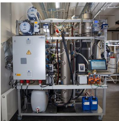
Abb 2: Zweistufige Versuchsanlage zur biologischen Erzeugung von Wasserstoff durch dunkle Fermentation
