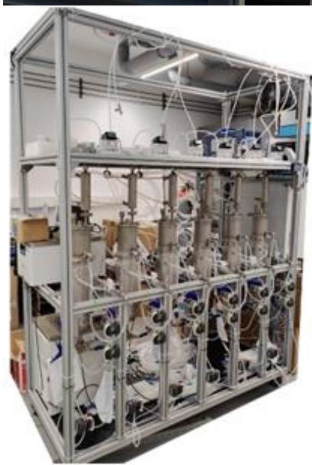
TDH (oben) und Festbettreaktor-Laboranlage (unten)
