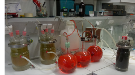
Abb. 1: reaktivierte Laborfermenter mit Pensanbiozönose
