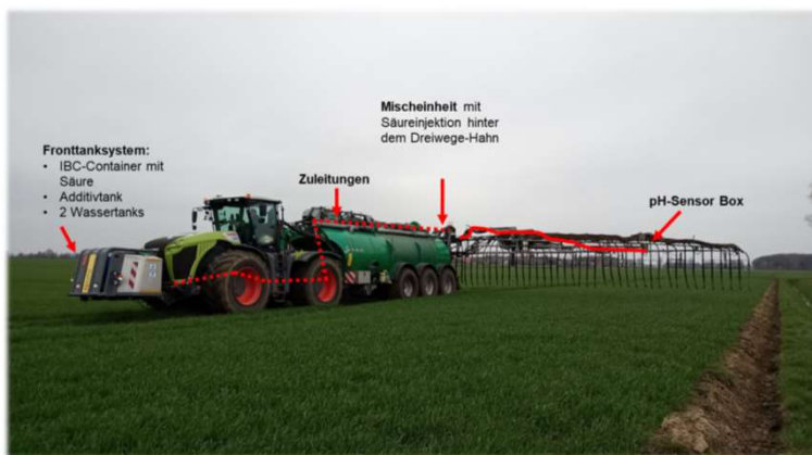
Abb. 2: Aufbau der Ansäuerungstechnik (© Howind, bearbeitet von Hass)
