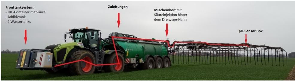
Abb. 1: Aufbau der Ansäuerungstechnik (© Howind, bearbeitet von Hass)
