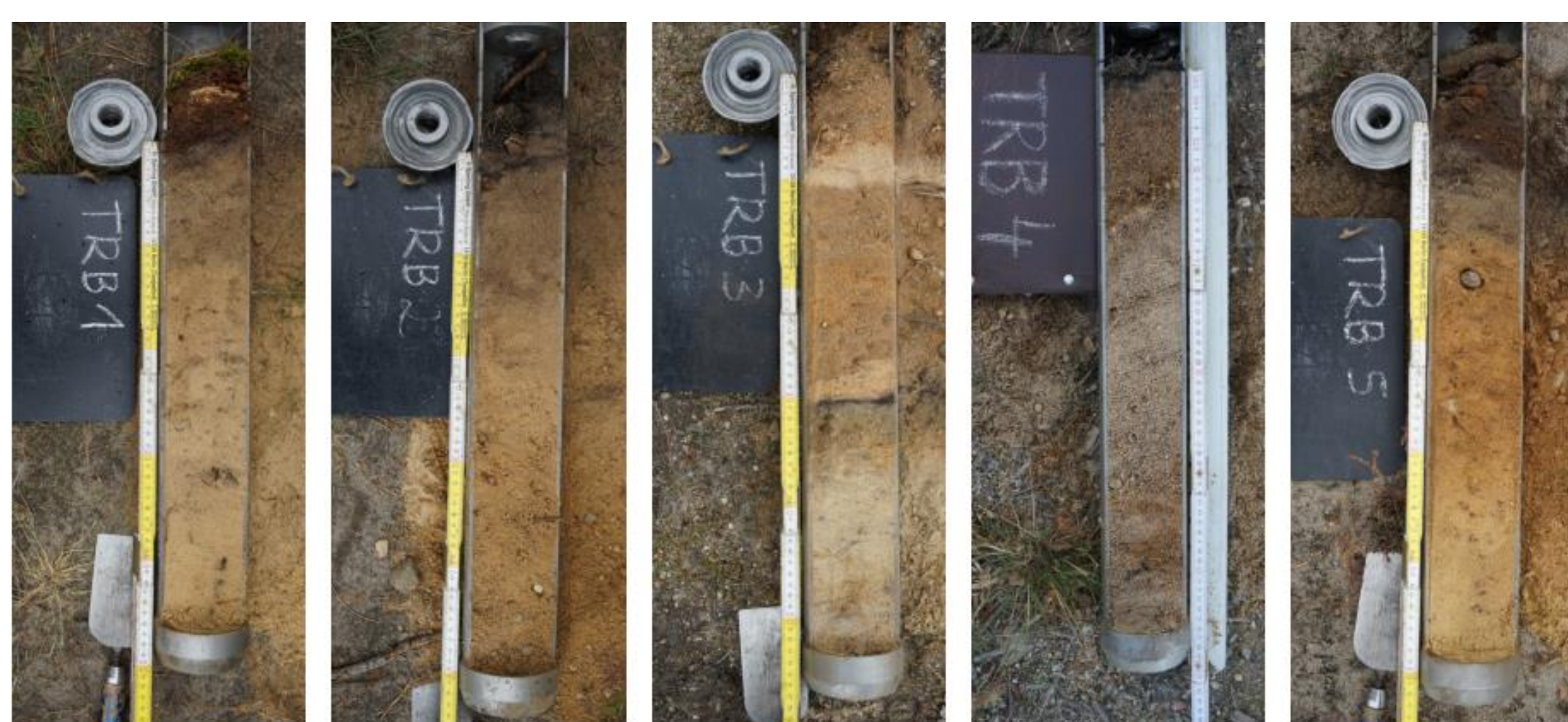
Links: Sickerwassergewinnung mit Saugkerzen in 10 und 20 cm Tiefe (0,6 Bar Unterdruck); Rechts: Entnahme Festphase mit Wurzelbohrer bis 60 cm Tiefe für alle Transektpunkte in Treuenbrietzen
