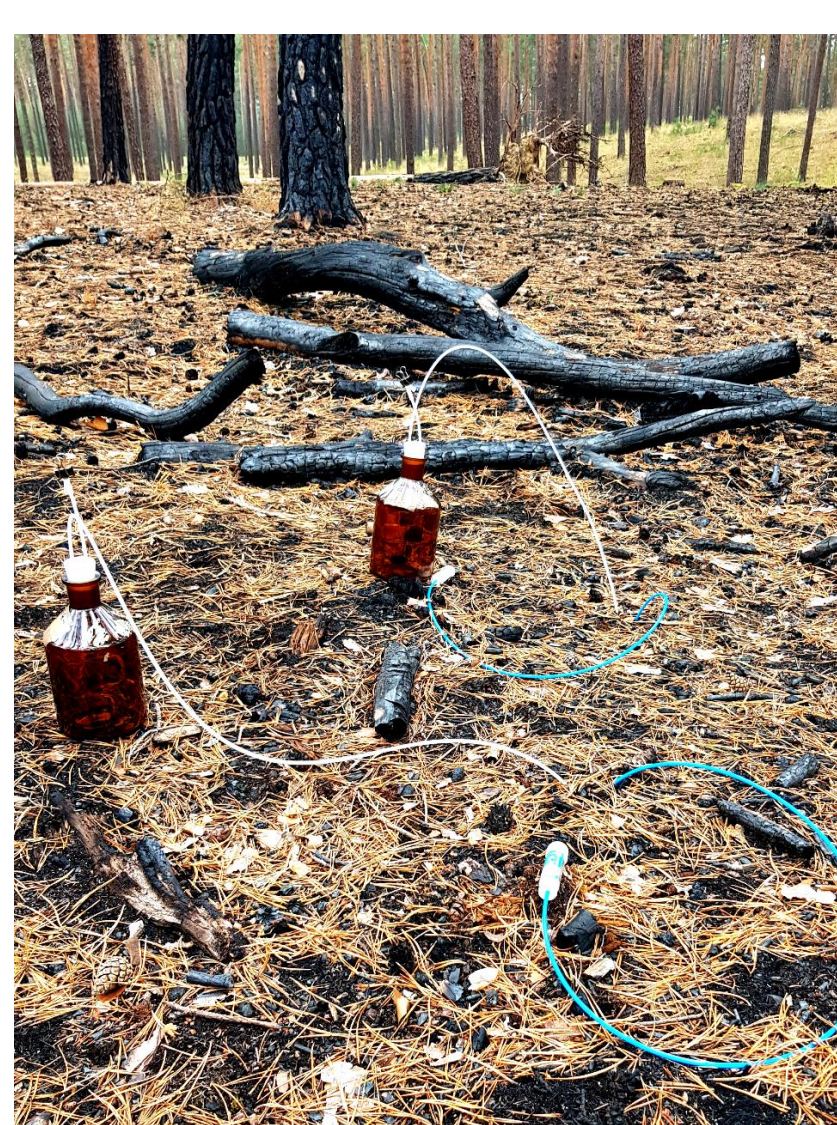
Links: Sickerwassergewinnung mit Saugkerzen in 10 und 20 cm Tiefe (0,6 Bar Unterdruck); Rechts: Entnahme Festphase mit Wurzelbohrer bis 60 cm Tiefe für alle Transektpunkte in Treuenbrietzen
