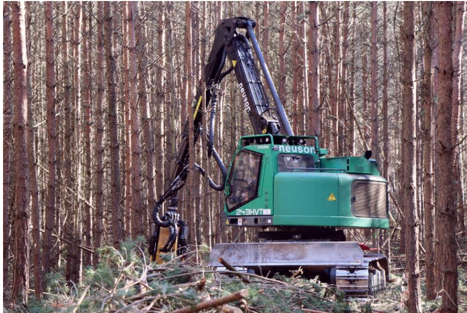
Geschützte Forsttechnik (Harvester- links und Forwarder- rechts) im Einsatz auf kampfmittelbelasteter Fläche im Forstamt Kaliß (Fotos: THOR, 2022)
