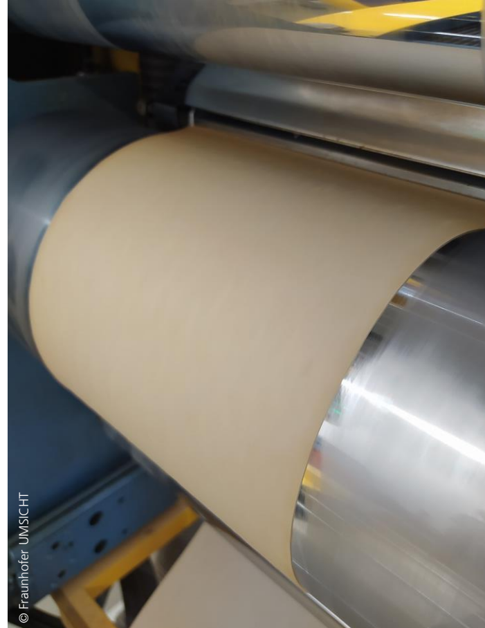
(links) Flachfolienextrusion von der Basisrezeptur, und (rechts) Flachfolie aus Basisrezeptur (Foliendicke 290 µm)
