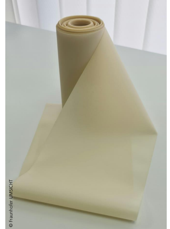
(links) Flachfolienextrusion von der Basisrezeptur, und (rechts) Flachfolie aus Basisrezeptur (Foliendicke 290 µm)
